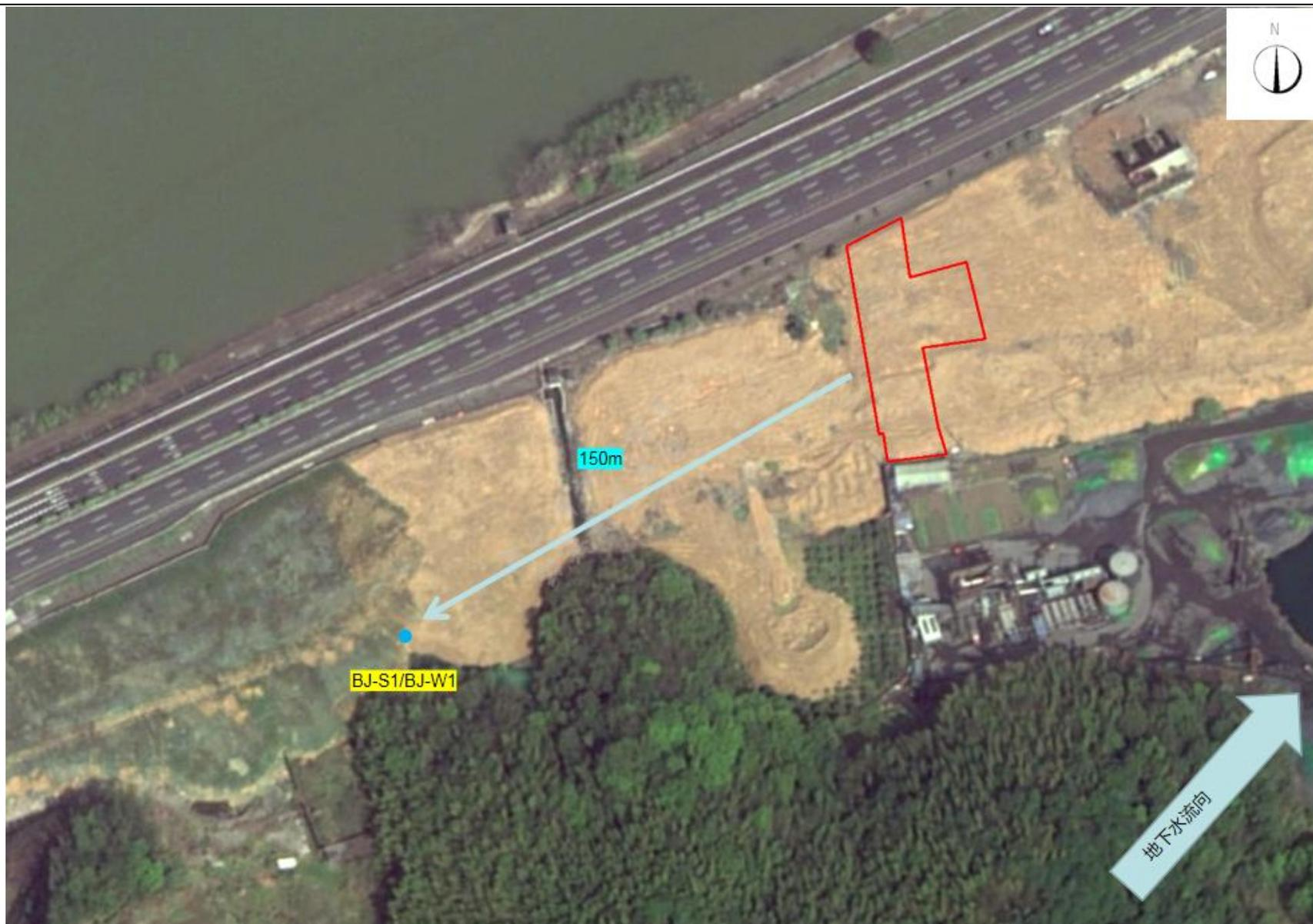
图 4.2-3 地块外对照点的土壤及地下水点位布设图
