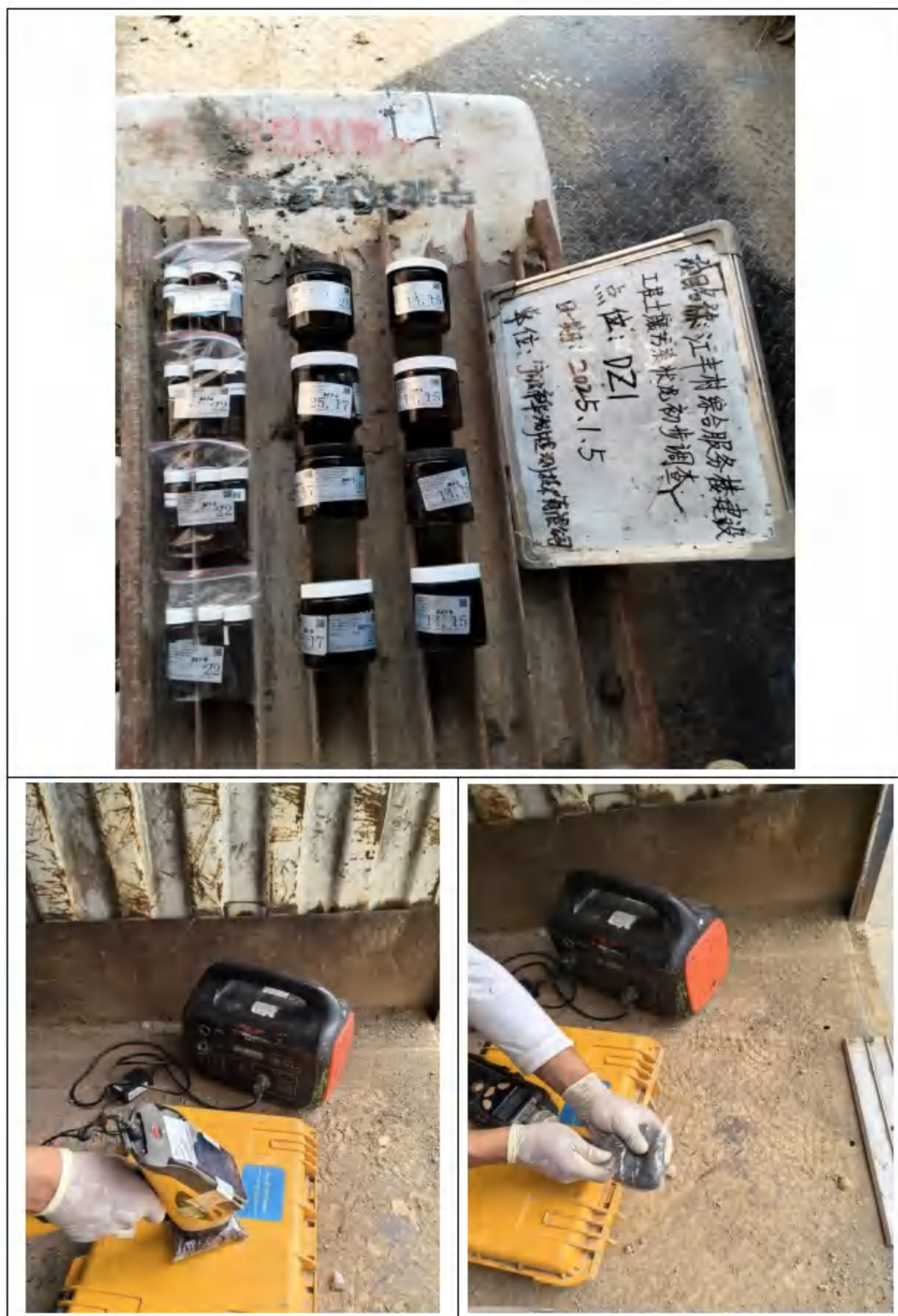
图 5.3-4 部分土孔采样、快筛及分样照片
