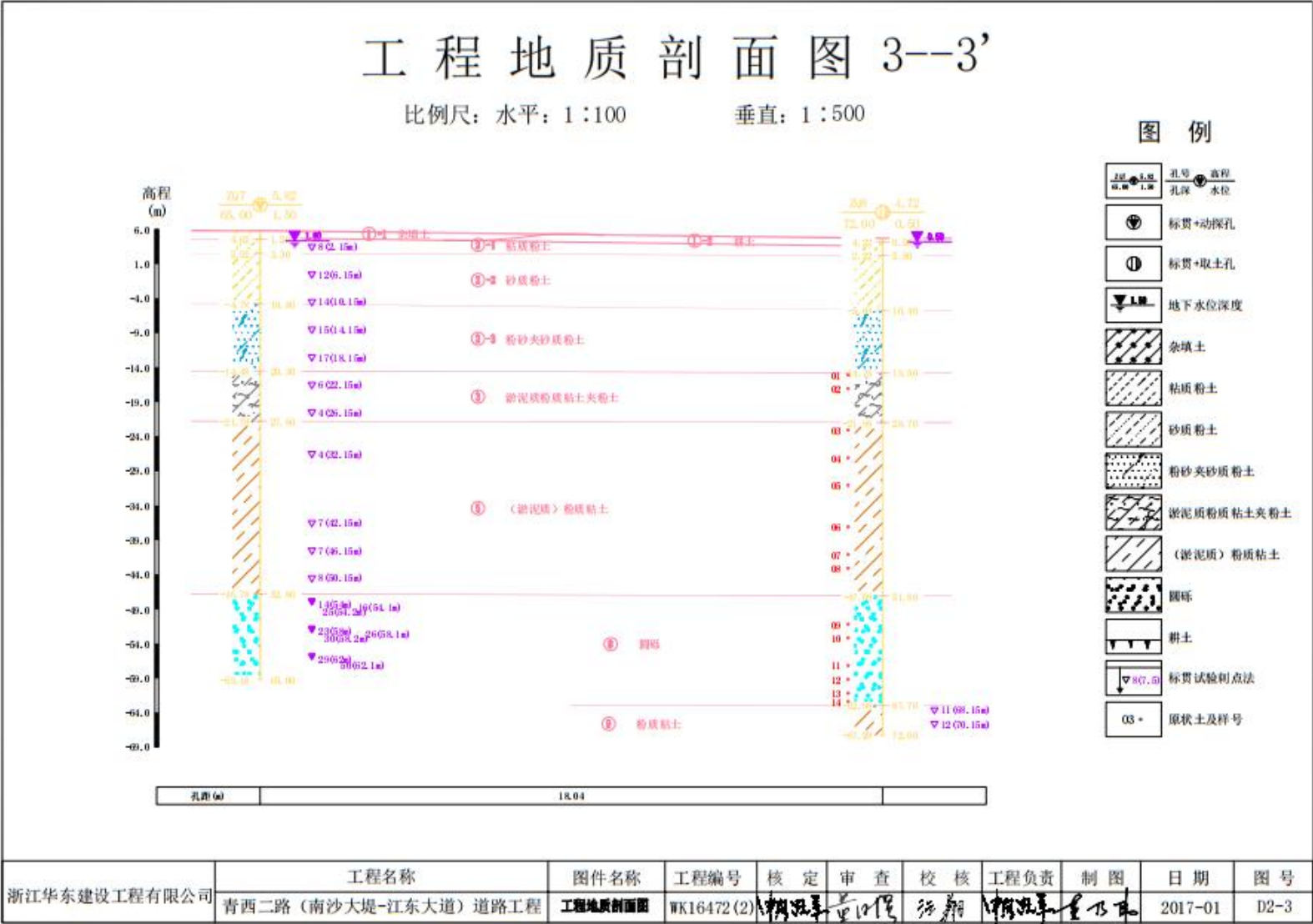
图 3.2-4 参考地勘工程地质剖面图
