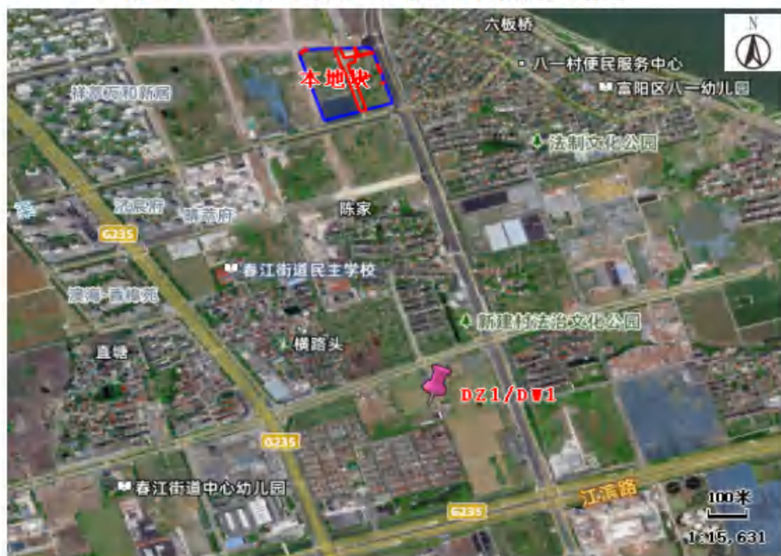
图 4.2-3 本调查地块外对照点土壤及地下水点位布设图
