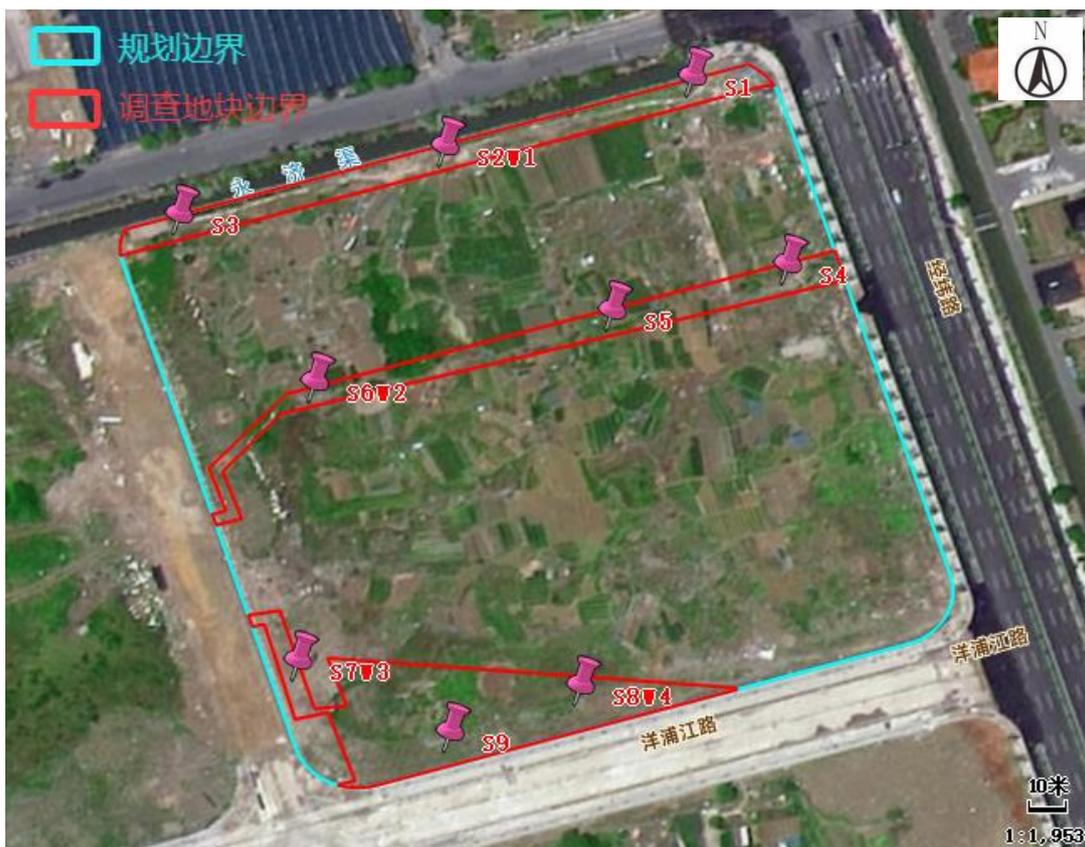
图 4.2-2 (3) 本调查地块内的土壤及地下水点位布设图 (现状)
